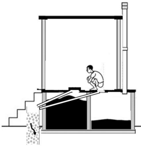
شكل رقم 12: تحويل السوائل في آبار التنفية بينما يتجمع البراز في حجرة البالوعة
