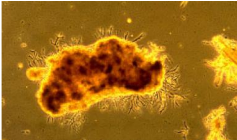
الشكل(٣) صورة مجهرية للندف البكتيرية ضمن السائل الممزوج بحوض التهوية
