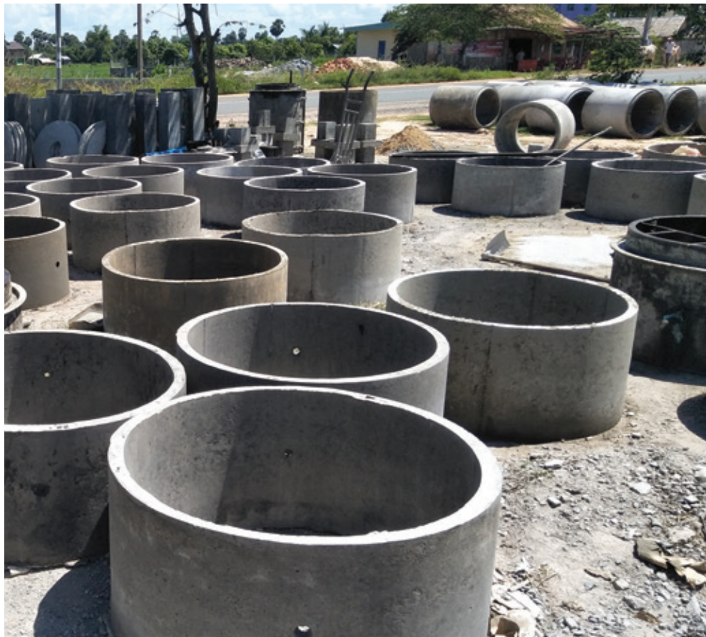
Buses en béton utilisées pour la construction de latrines.
