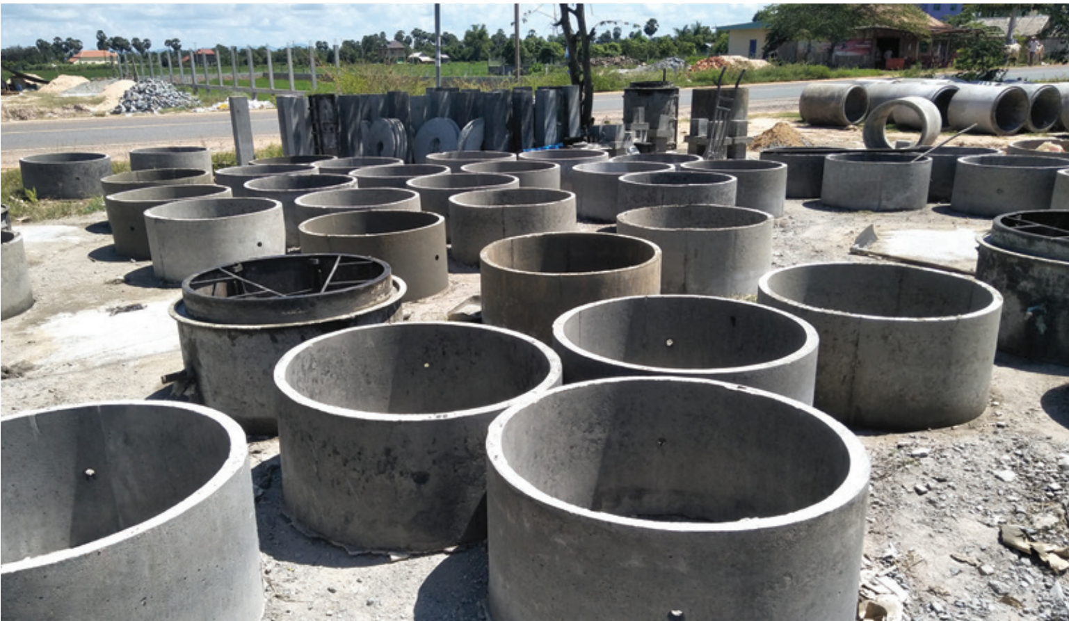
Anillos de concreto utilizados en la construcción de letrinas.
