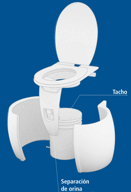
Fig.b: Despiece de inodoro seco con separación de orina INTI
