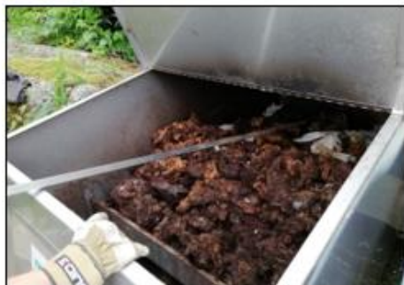
5. Käymälämakki haravoituna säiliön takaosaan "lepäämään". Kuivaa makkia kasteltiin lapiomalla suotonestettä sen päälle.
