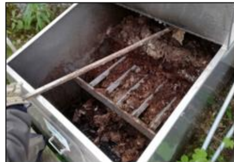
4. Vanhin käymälämakki poistettu, jonka jälkeen keskivaiheilla oleva makki "haravoidaan" jätessäiliön takaosaan.
