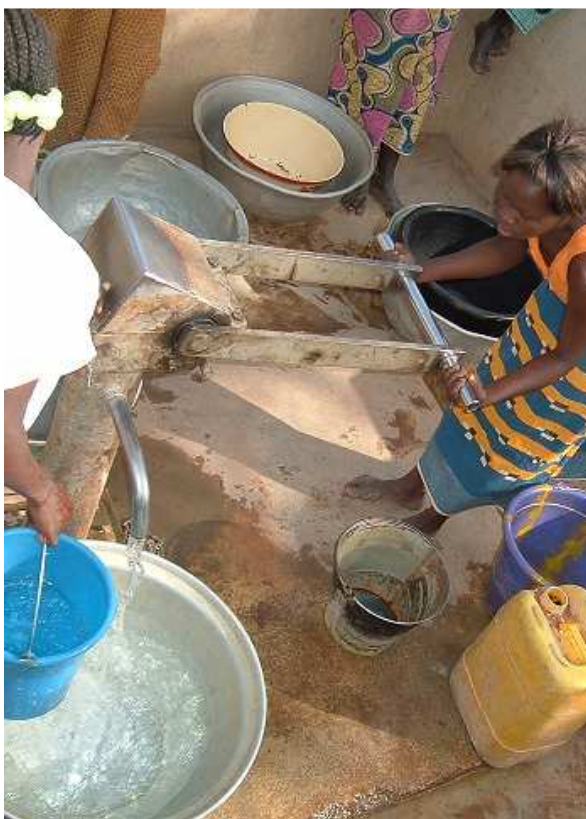
Photo 6 : Forage équipé d'une pompe manuelle (type Vernier, importée).
