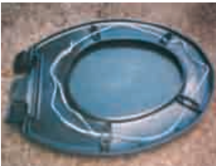
Photo 5-7 : Anneaux de fil de fer ajoutés au siège en plastique
